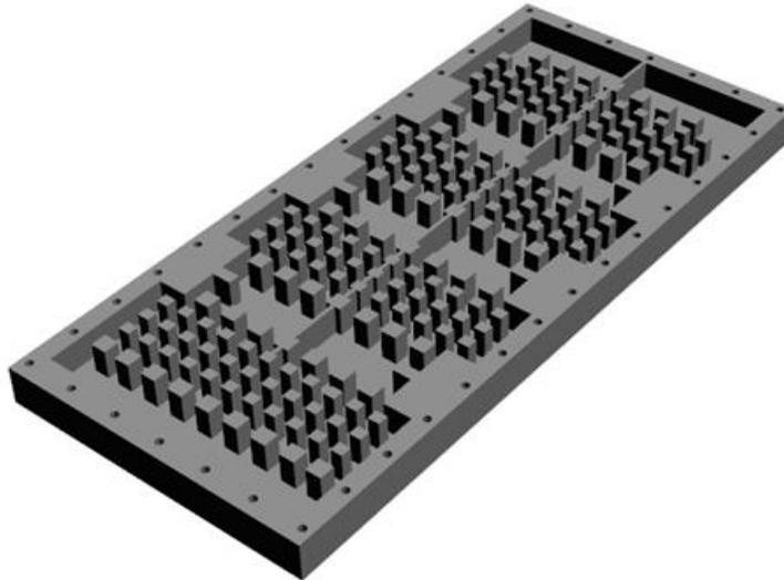
Figura C.13 – Vista de projeto do interior de um dos dissipadores para refrigeração dos módulos IGBTs.
