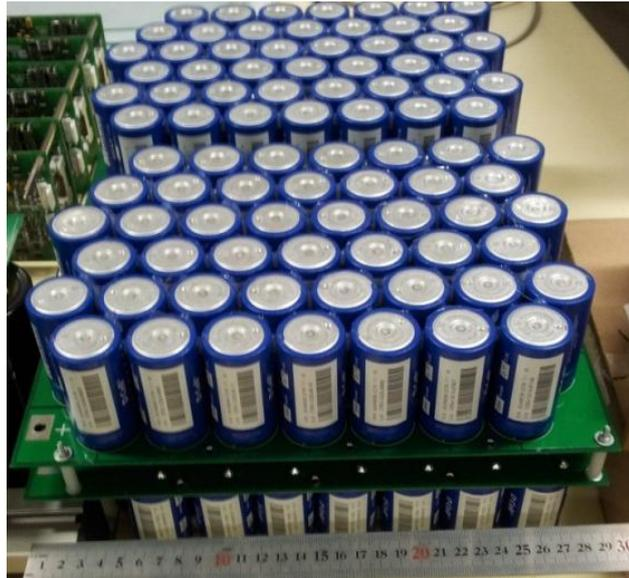
Figura 5.14 – Pormenor do banco de supercondensadores do SAE.
