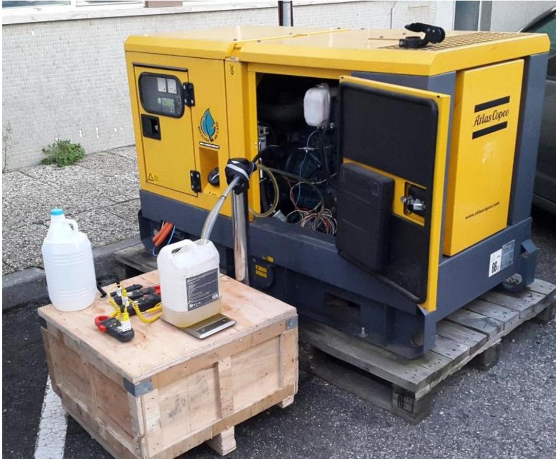
Figura 5.31 – Vista geral do ensaio de medição de consumo de combustível do grupo gerador-Diesel.
