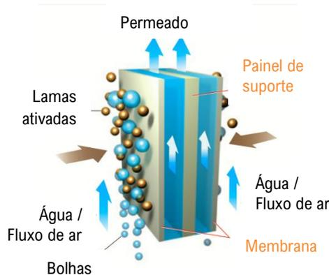
Figura 2.6 – Representação esquemática do módulo de placa e quadro [fonte: QUA tratamento, 2018]
