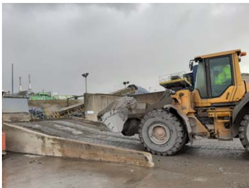
Figura 3 - Colocação das cinzas de fundo na tremonha com grelha vibratória
