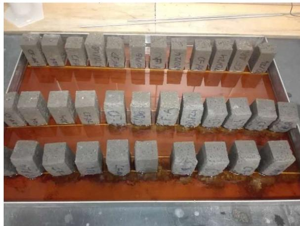
Figura 3.21 - Ensaio de absorção de água por capilaridade com as famílias de CF-AN e CF-AR
