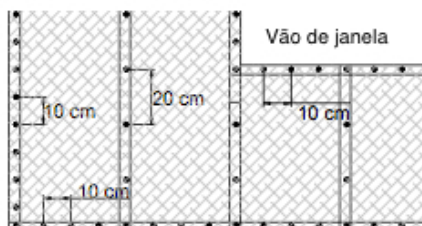
Figura 2.54 - Disposição e espaçamento dos parafusos na ligação das placas aos montantes (Adaptado de ConsulSteel, 2002)
