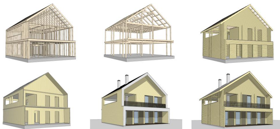
Fig. 464 - Tipos estruturais considerados (reticulados leves, porticados, paredes pesadas de toros, painéis pesados de lamelados colados - CLT) e as soluções arquitectónicas: preferencial e em toros (Desenhos do autor).
