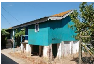
Fig. 141 - Habitações na Palhota com revestimento em painéis de contraplacado (Fotos autor).
