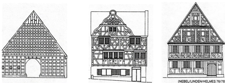
Fig. 31 - Regiões e tipos de "fachwerk" na Alemanha: Saxônico, Francônio e Alemânico ( http://home.arcor.de/mark.oehler/Holzbau/Fachwerk.htm ).
