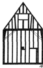
Fig. 54 - Estrutura da casa Fairbanks, Dedham, Massachusetts - 1636 (Clayton, 1990).
