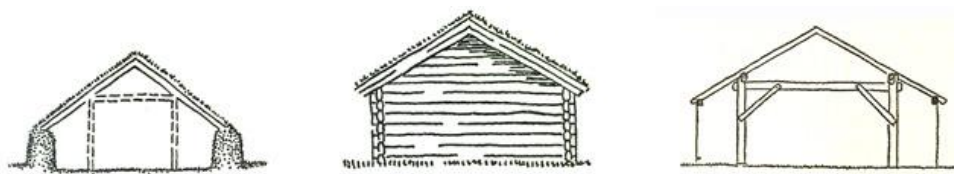
Fig. 10 - Princípios estruturais na Noruega: estrutura mista, paredes pesadas de toros e construção porticada (Hansen, 1971).
