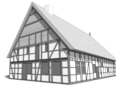
Fig. 29 - Reticulados pesados tipo Fachwerk . Perspectiva da casa Panecke na região de Hamburgo (século XIX) (Moyan, 2009).
