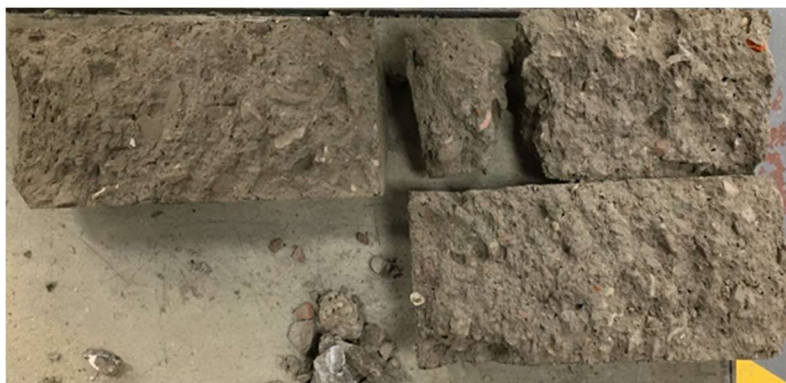
Figura 29 - Pormenor de provetes activados alcalinamente com AR ensaiados à tração a 28 dias.
