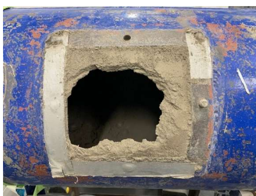
Figura 13 - Pormenor de CFRSU agarrada às paredes do moinho.
