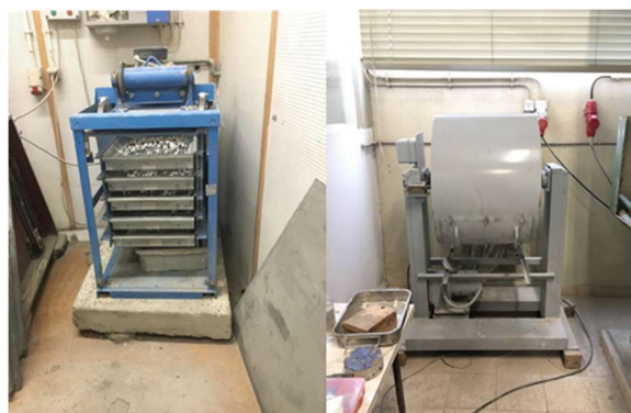
Figura 9 - Processo de peneiração (esquerda) e moagem via máquina de Los Angeles (direita).
