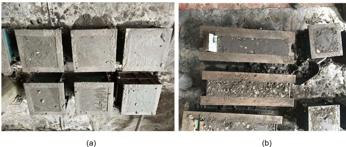
Figura 18 - Provetes após (a) e antes utilização de bórax (b).
