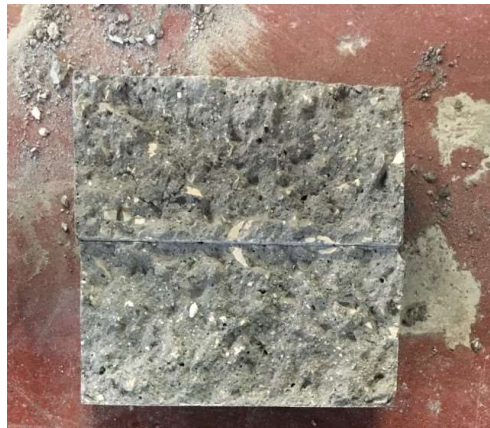
Figura 27 - Pormenor de provete activado alcalinamente com AN ensaiados à tracção a 28 dias.
