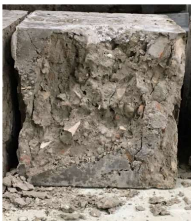
Figura 25 - Pormenor de provete activado alcalinamente com AR ensaiado
