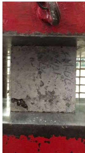
Figura 20 - Pormenor de ensaio de resistência à compressão num cubo.
