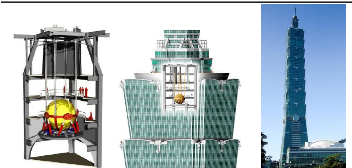
Figura 3-8: Esquemas do TMD utilizado no edifício Taipei 101 e uma fotografia deste (Irwin, Kilpatrick, & Frisque, Friend or Foe, Wind at Height, 2008)
