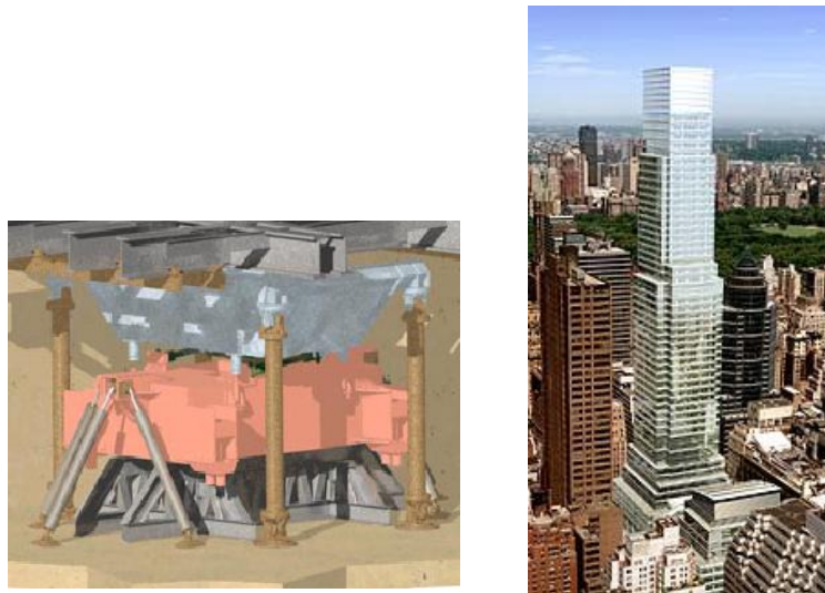
Figura 3-9: Esquema do TMD aplicado no edifício Bloomberg Tower e a sua fotografia (Irwin, Kilpatrick, & Frisque, Friend or Foe, Wind at Height, 2008)
