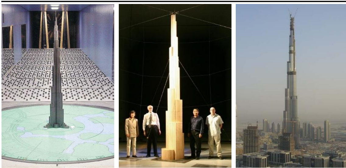
Figura 4-2: Burj Dubai – modelo aeroelástico à escala 1:500, à esquerda, modelo à escala 1:50 da parte de cima do edifício para testes de números de Reynolds altos e fotografia em construção, à direita (Baker, Pawlikowski, & Young, 2009)
