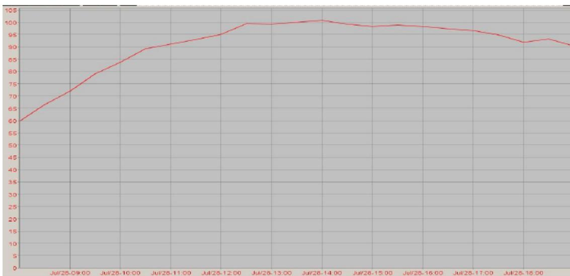
Figura F.1 – Diagrama de carga da linha L6112 dos dias das medidas, valores em amperes [A]
