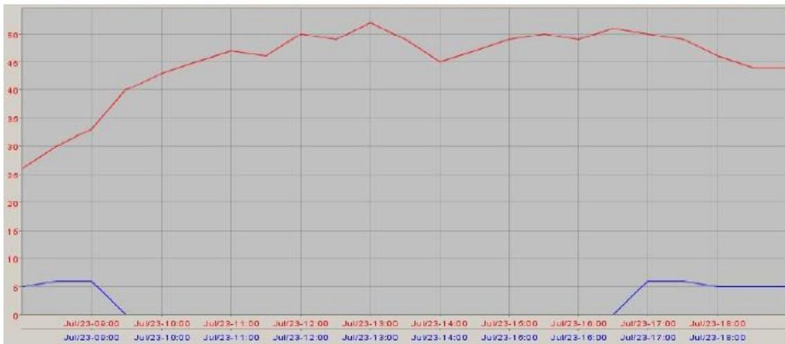
Figura E.1 – Diagrama de carga da linha L3127 e L3128 nos dias das medidas, valores em amperes [A]
