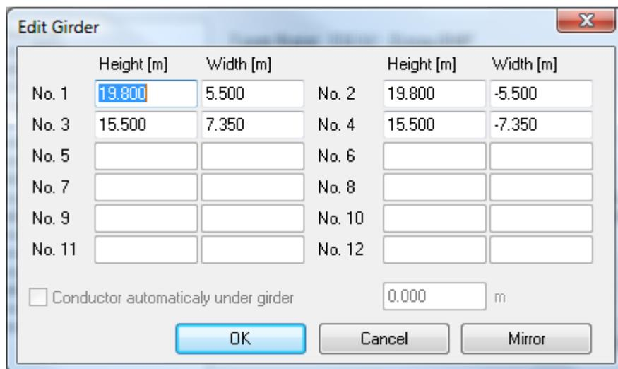
Figura A.4 – Menu de configuração das travessas, definição do número, do comprimento e posicionamento das mesmas, ou seja, definição da configuração da linha (esteira, trevo, etc)
