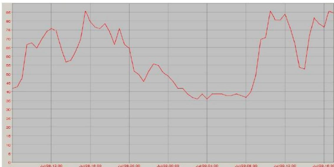
Figura C.1 – Diagrama de carga da linha L1081 dos dias das medidas, valores em amperes [A]
