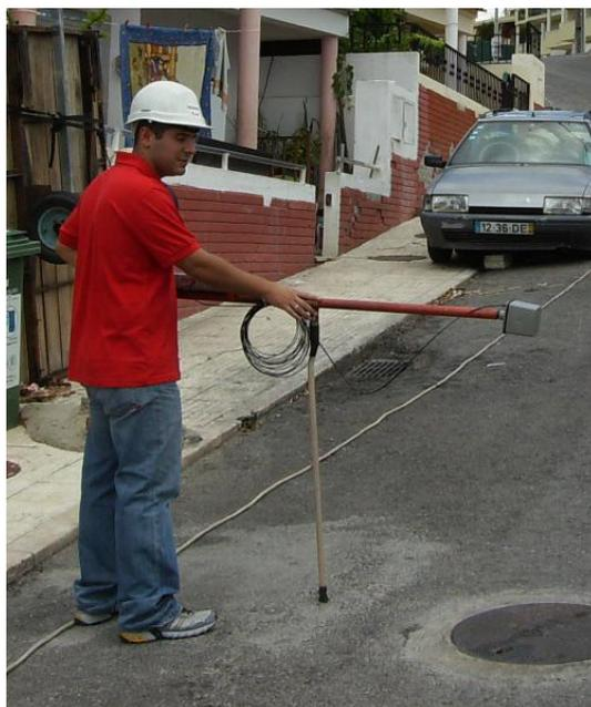
Figura 3.1 – Exemplo do posicionamento do instrumento de medida e da definição do perfil de medida
