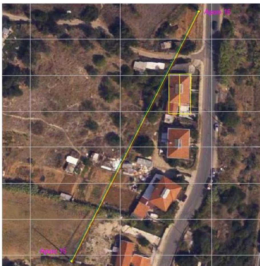
Figura 5.1 – Posicionamento dos apoios da linha L107
