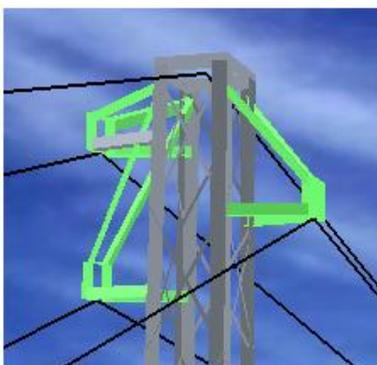
Figura 7.4 – Configuração dos apoios 27, 28 e 29 em trevo com cabo de guarda
