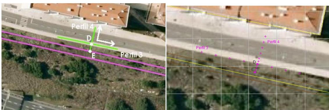
Figura 8.7 – Identificação dos perfis de medição do vão P51/53 – P52/54, relatório das medidas (11) à esquerda e software EFC-400 à direita
