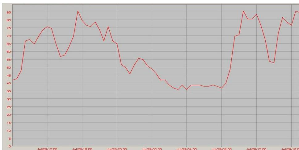
Figura 3.2 – Exemplo de diagrama de carga do dia das medidas para a linha de 10kV simples, valores em amperes [A]
