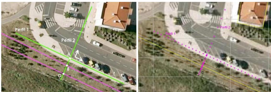
Figura 8.6 – Identificação dos perfis de medição do vão P50/52 – P51/53, relatório das medidas (11) à esquerda e software EFC-400 à direita
