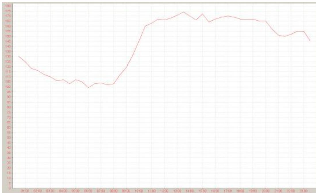
Figura D.1 – Diagrama de carga da linha L107 do dia das medidas, valores em amperes [A]
