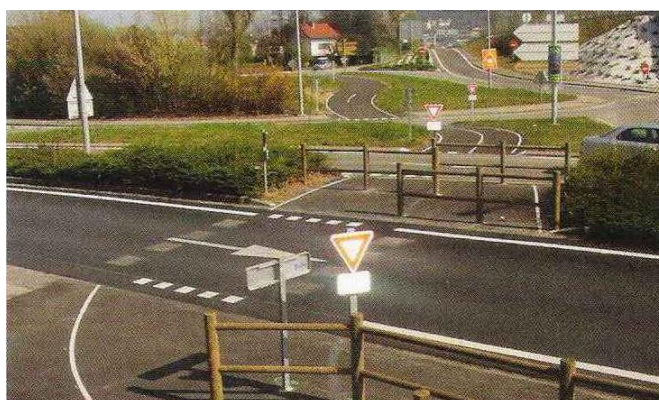
Figura 3.12 – Exemplo de refúgio central de forma a aumentar a segurança dos ciclistas (fonte: CERTU, 2005)
