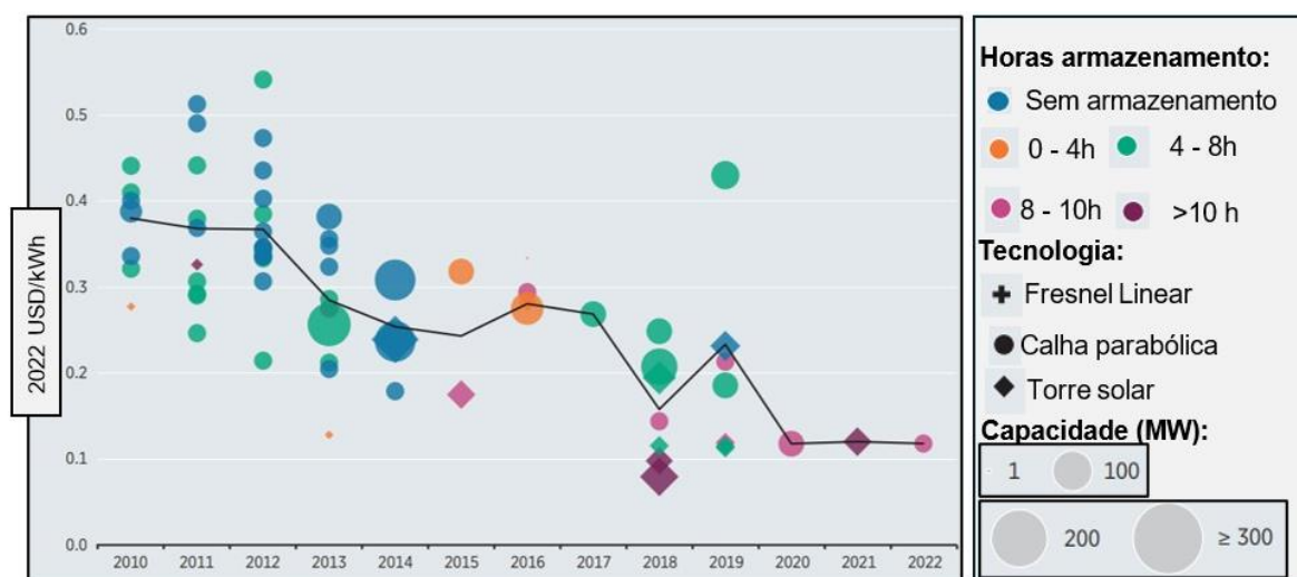
Figura 3 -LCOE para projetos de CSP consoante tecnologia, capacidade, armazenamento. Modificado de [4].
