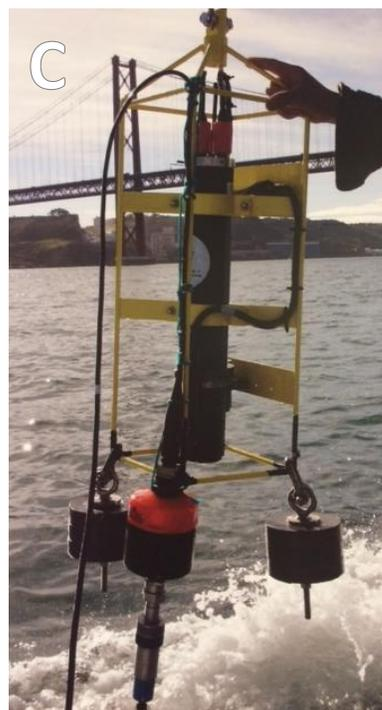
**Figura 3.5.** Barco e aparelhos utilizados durante as campanhas ao porto de Sines. A – Barco disponibilizado pela Seaculture – Aquicultura, S.A. para as campanhas. B – Sonda multiparamétrica, modelo YSI-Exo2, logger e computador de campo. C – Sonda CTD, modelo FSI NXIC CTD
