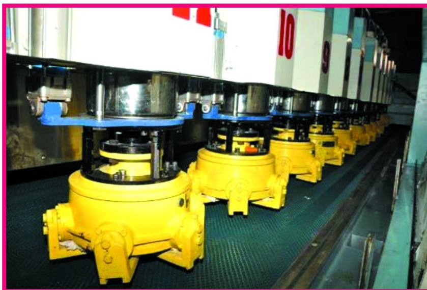
Fig.1 Tipica macchina luciatrica multiteste usata nel settore della pietra ornamentale [4] Typical multiple head polishing machine used by the ornamental stone industry [4]
