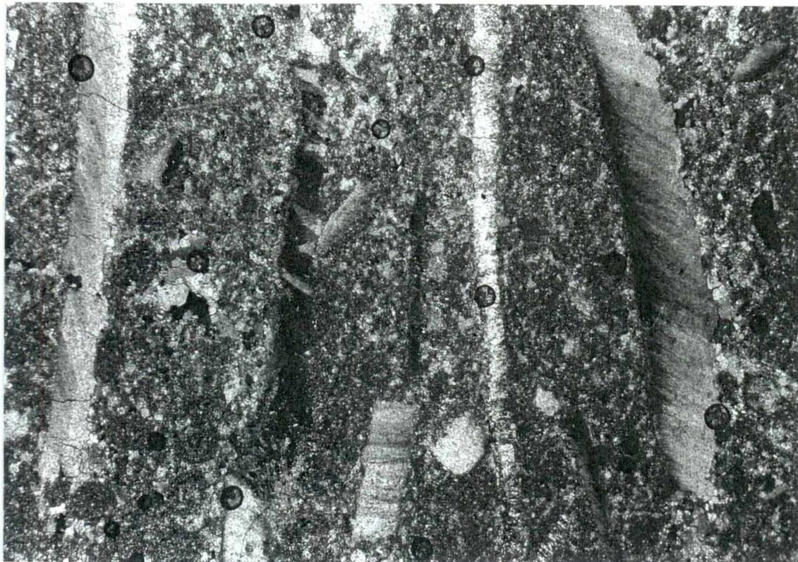
Fig.10 - Lioz do Murganhal. Secções de rudistas em disposição sub-paralela. Observa-se a calcite fibrosa de alguns bioclastos. (x 37; N +).
