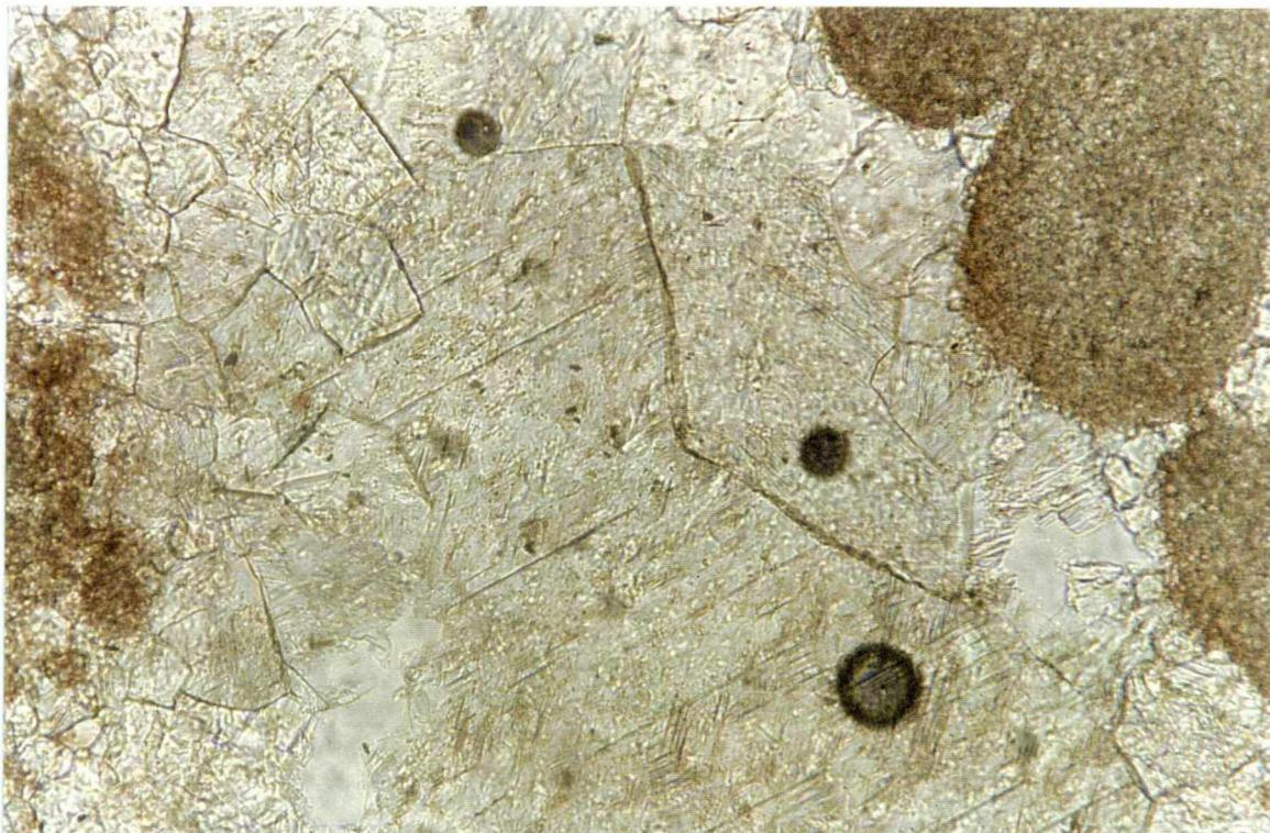
Fig.21 - Encarnadão tipo vidro. Calcite intersticial de grão grosso, com predomínio de juntas intercristalinas planares bem definidas (x 235; N | | ).
