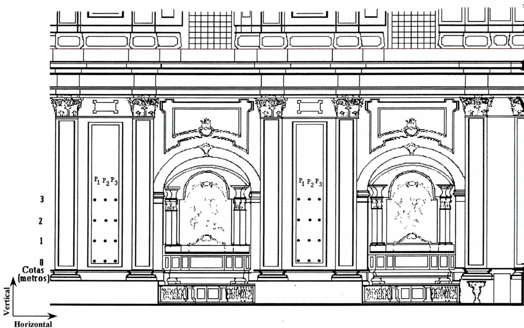
Fig.108 - Pormenor de um dos alçados interiores da Basílica, onde se pode ver a implantação da malha de amostragem sobre os "painéis" (Escala: 1/129).
