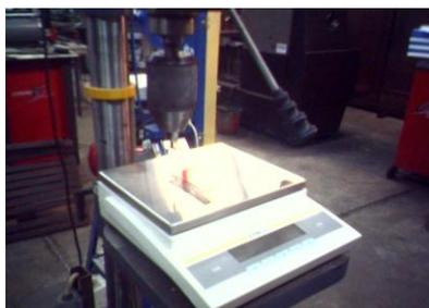
Figura 1.3 – Determinação experimental da força do fixador
