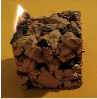
Figura 2.24: Combustão de um bloco de cortiça [S6]
