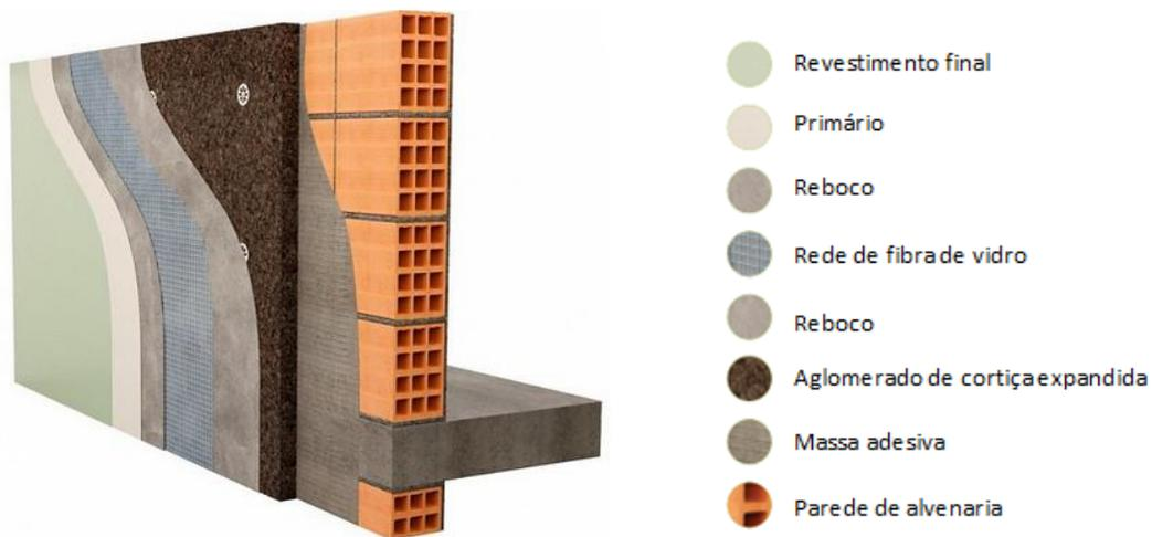
Figura 4.35: Sistema de ETICS de Amorim Isolamentos, S. A (Rw=54dB) [S16].
