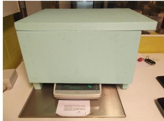
Figura 2.18: Balança para pesagem dos provetes [7]
