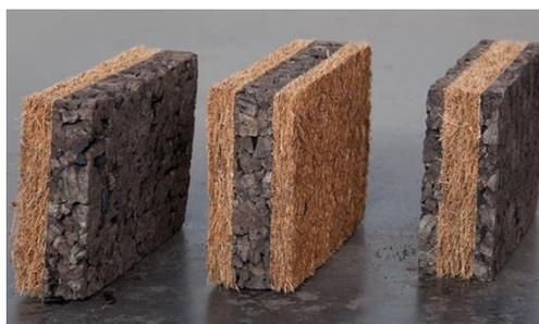
Figura 4.37: Soluções de parede em fibra de coco colados topo-a-topo ou em forma de sandwich [S16].
