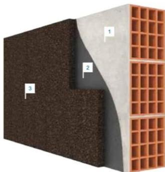
Figura 3.30: Solução de revestimento de parede ICB. 1 – Suporte; 2 – Superfície de colagem; 3 – Revestimento exterior de ICB [S12].
