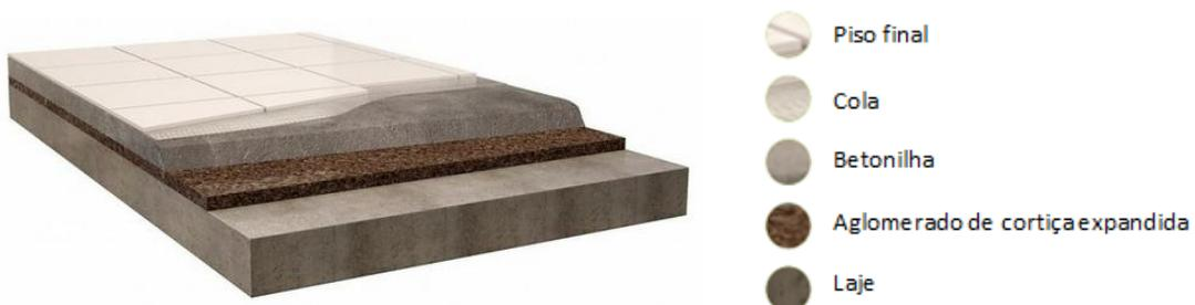
Figura 4.42: Solução de lajeta flutuante com revestimento de mosaico (Rw=53dB) [S16].
