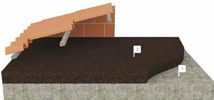
Figura 4.30: Solução de cobertura inclinada com isolamento directamente sobre a laje de esteira. 1 – Laje de esteira; 2 – Aglomerado de cortiça expandida [S11].
