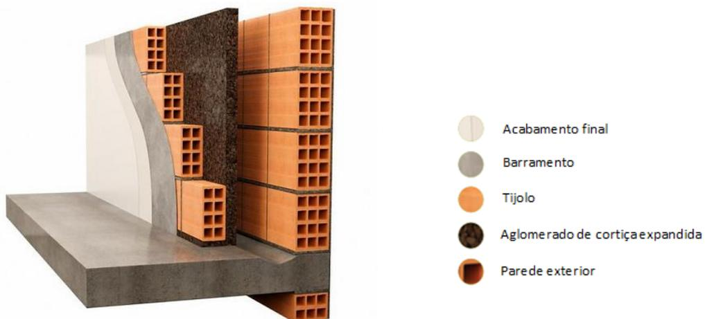
Figura 4.36: Sistema parede dupla com preenchimento parcial do isolamento na caixa-de-ar de Amorim Isolamentos, S. A (Rw=53dB) [S16].
