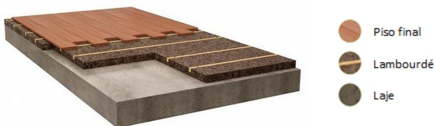
Figura 4.43: Sistema de suporte para soalho pregado de Amorim Isolamentos, S. A. [S16].
