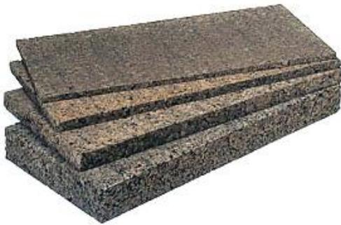
Figura 3.18: Isolamento de aglomerado expandido de cortiça [S3].
