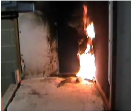
Figura 2.25: Ensaio do objecto em combustão segundo a norma EN 12823 [11]
