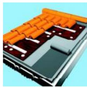
Figura 3.24: Isolamento de cobertura inclinada [S18].
