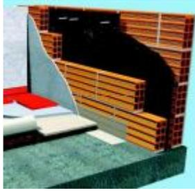
Figura 3.21: Isolamento de parede com caixa-de-ar [S18].
