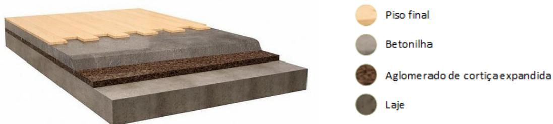
Figura 4.41: Solução de lajeta flutuante com revestimento de madeira (Rw=53dB) [S16].
