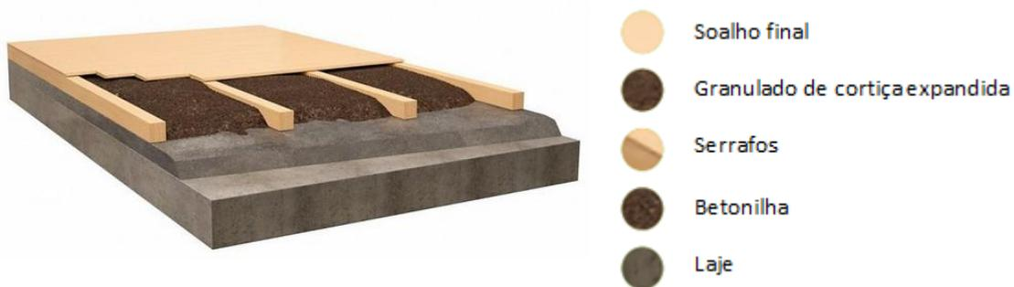
Figura 4.44: Sistema de enchimento de caixa de soalho de Amorim Isolamentos, S. A. [S16].
