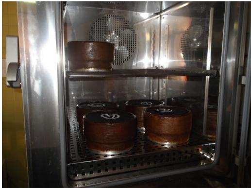
Figura 2.17: Colocação dos provetes na câmara condicionada [7]
