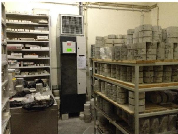
Figura 3.8 – Armazenamento dos provetes em câmara seca
