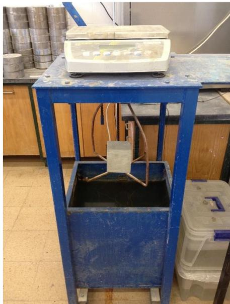
Figura 3.9 – Equipamento utilizado para o ensaio de massa volúmica em estado endurecido
