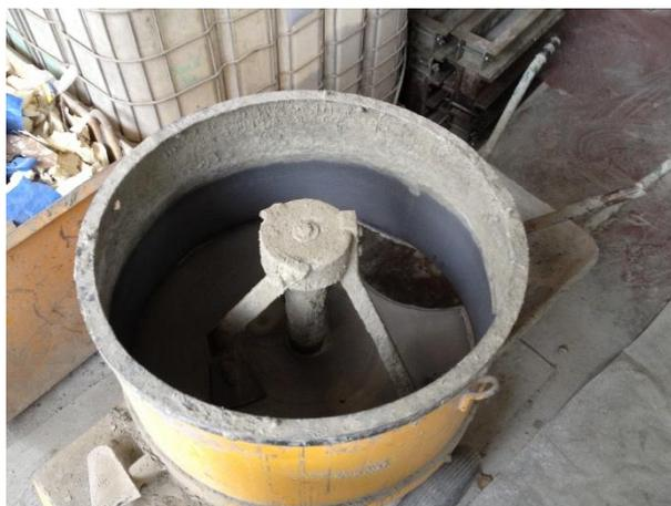
Figura 3.5 - Betoneira utilizada na campanha experimental
