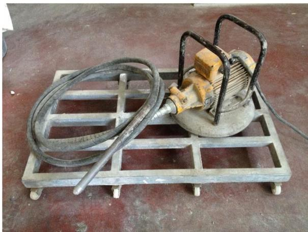
Figura 3.6 – Vibrador de agulha
