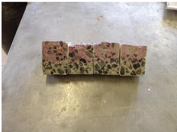
Figura 3.15 – Resultado final do ensaio de resistência à profundidade de carbonatação
