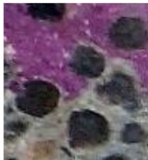
Figura 4.9 – Frente de carbonatação em redor das partículas de agregado leve
