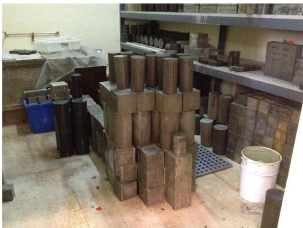
Figura 3.7 – Cura dos provetes em câmara húmida
