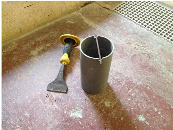
Figura 3.13 – Equipamento para divisão em duas metades de um provete
