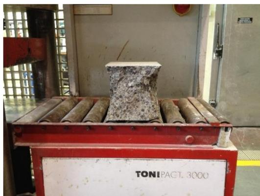
Figura 3.11 – Provete de betão após o ensaio de resistência à compressão
