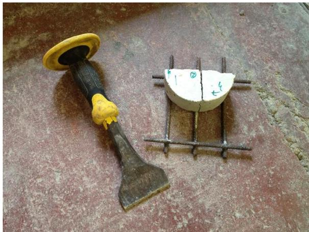
Figura 3.14 – Malha utilizada para a divisão final dos espécimes
