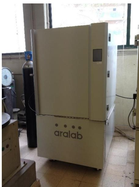
Figura 3.12 – Câmara onde se realizou o ensaio de resistência à carbonatação
