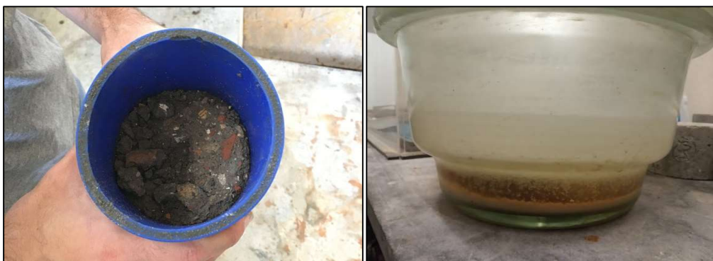
Figura 36 - Problemas de estabilidade da matriz do betão produzido com AR e CFRSU (esquerda) e perda de massa dos provetes (assente no fundo) após 24 h na máquina de vácuo (direita)
