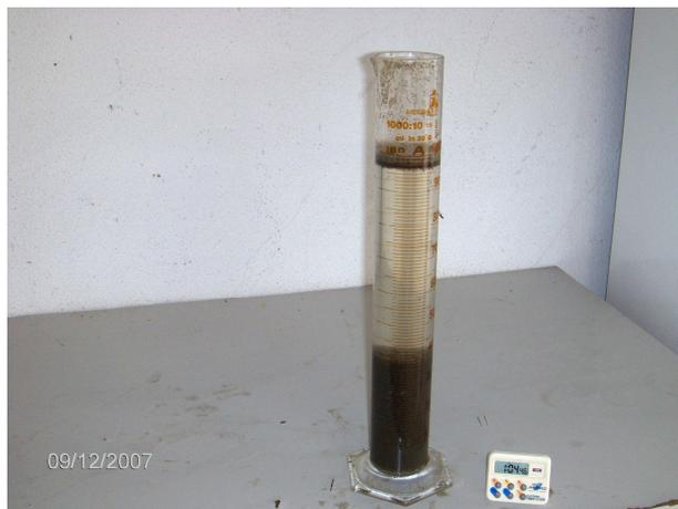
**Medição do volume de lama biológica sedimentada**
